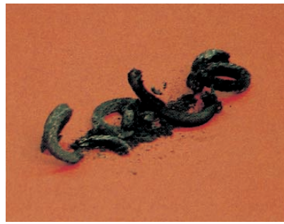
Treccia in amianto grafitato dopo l'uso. Difficoltà nella rimozione dei singoli anelli.
